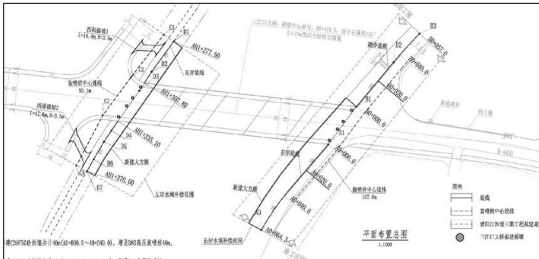
图3.3-7 本工程堤防加固防渗补偿示意图
