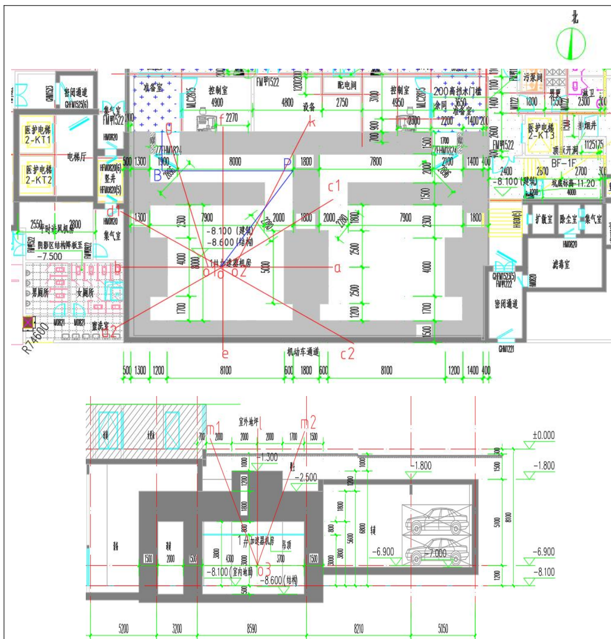
图 7-1 1#加速器机房关注点剂量率参考控制
